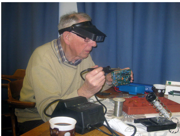
Derek löder komponenterna till sin MKARS transceiver
