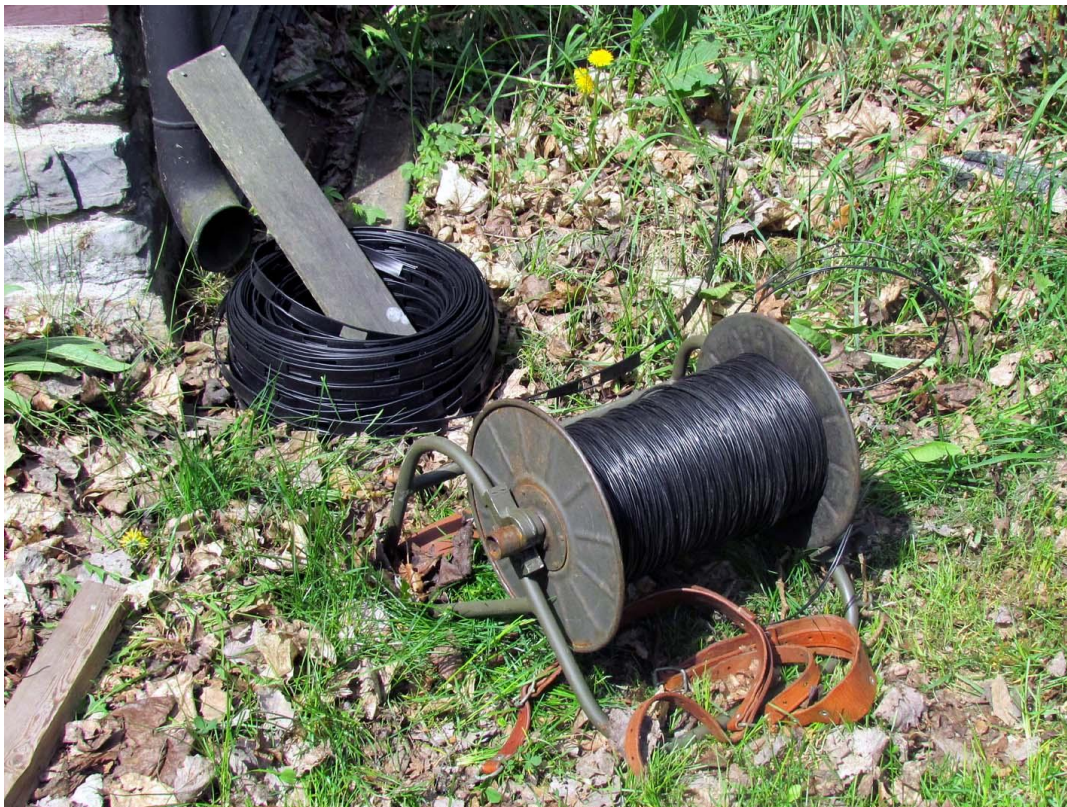
Antenntråd och nedledning. Observera träbiten som håller ordning på det hela.
