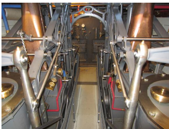
De båda ångmaskinerna med vedpannan i bakgrunden
