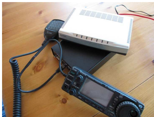
Remoterig, modem och panelen till IC706.
