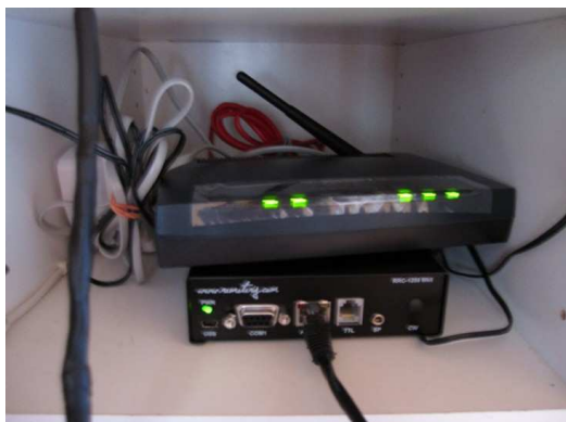
Remoterig och modem på radiosidan Radiodelen till IC706 är placerad ovanför.
