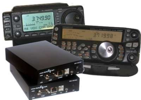
Remote Control 1258 används på riggar med delat montage mellan radio o panel
