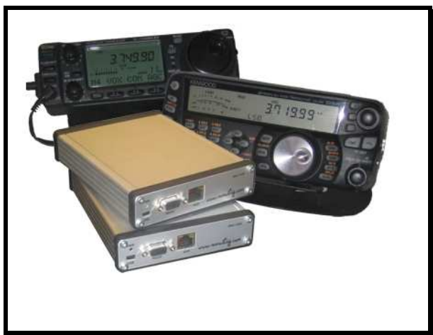
Bilden visar de två parvisa fjärrstyrlådorna som används för att fjärrstyra riggar med delat montage. Ena lådan till panelen och den andra till radion, Här visas de två lådorna med två riggar som har möjlighet till delat montage. Kenwood TS-480 i förgrunden och Icom IC-706 längst bak.
