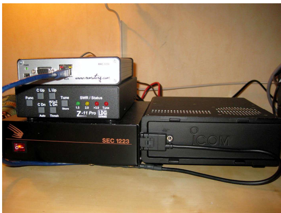
Installation på Kornudden. Nätaggregat, autotuner och den grå lådan för fjärrstyrningen till vänster. Radiodelen utan panel till höger.
