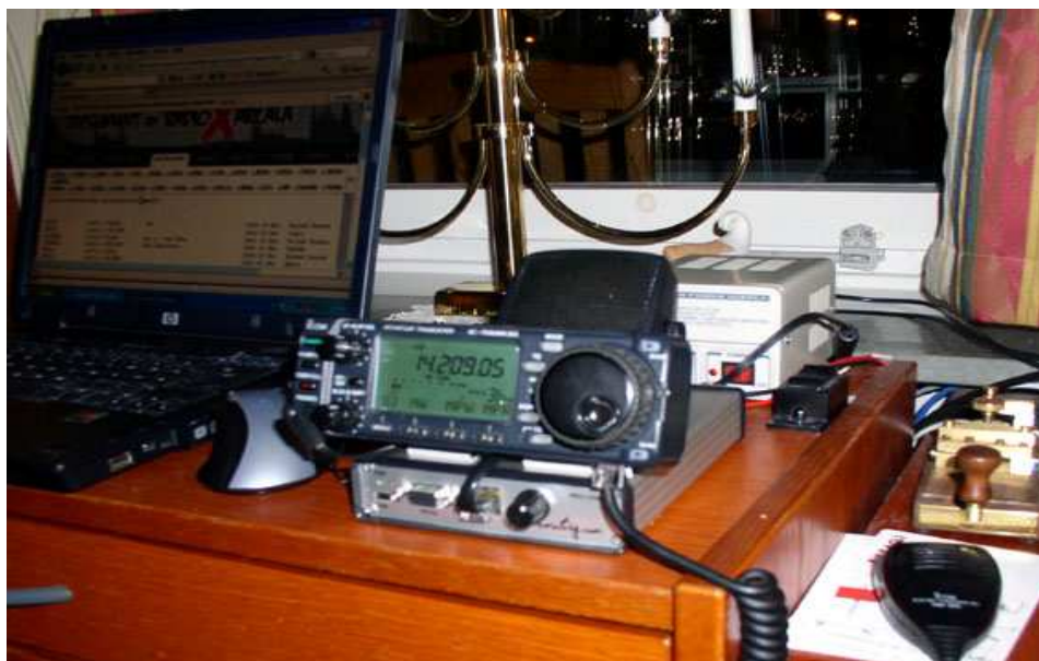
Paneldelen och högtalare monterad ovanpå fjärrstyrlådan
