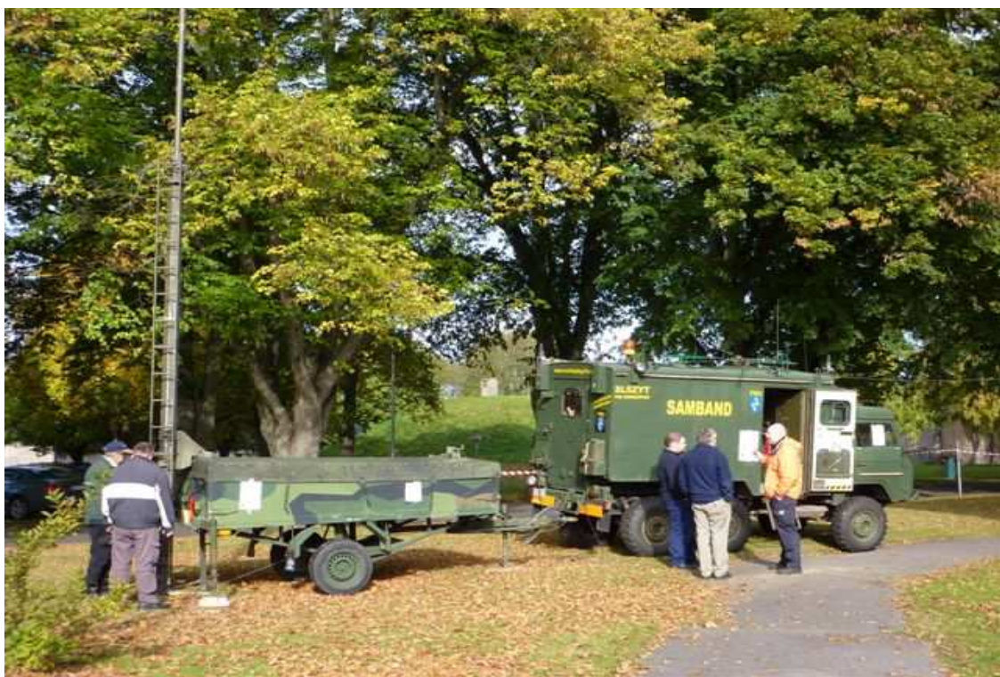
FRO's sambandsbil med mastvagn. Masten höjdes här utan staglinor till 6 meter. Med staglinor får den höjas till 22 meter.
