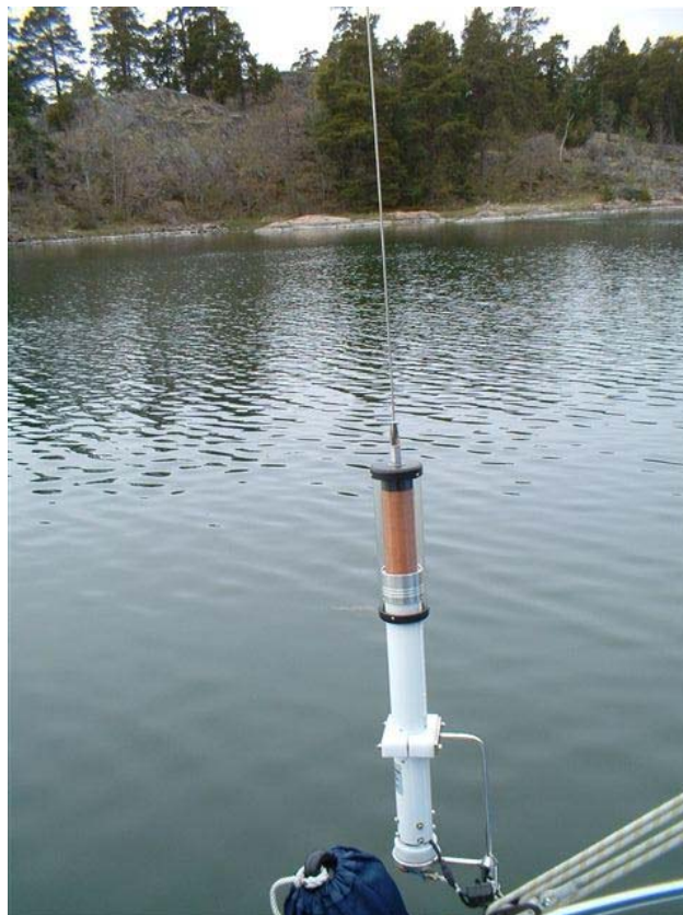
Screwdriverantenn monterad på Nadja
