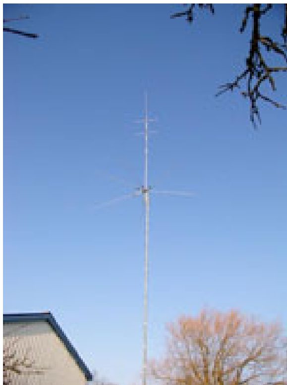
Vertikalantennen för 80 – 40 – 20 - 15 – 10 – 6 meter. Monterad tio meter upp.
